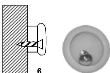
Montaža SPRINT paket mehanizma moguća je samo na krilo prozora ili na okvir, na način kako je prikazano na slici 6. Kod montaže paketa SPRINT bitno je paziti da se točno odmjeri položaj nosača kako bi se izbjeglo preklapanje s mehanizmom ili špulama. Nosači se učvršćuju odvojeni od ostatka paketa koji se postavlja na iste nakon ugradnje na predviđeno mjesto.
